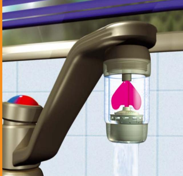
Пропеллер в форме сердца, изготовленный из материала DuPont™ Delrin®, изменяет цвет с фиолетового на розовый, когда водопроводная вода становится слишком горячей. Delrin® был выбран из-за отличной устойчивости к быстрым изменениям температуры холодной и горячей воды и устойчивости к давлению.
