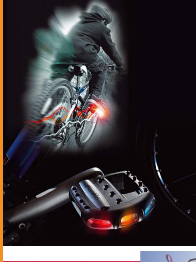
В устройстве подсветки велосипедных педалей компании Pedalite без батареи со встроенной системой преобразования кинетической энергии для изготовления основы педалей был выбран материал DuPont™ Zytel® из-за его выдающейся размерной стабильности и ударной прочности, а для изготовления опоры подшипника и шкива оси – материал DuPont™ Delrin® ST ввиду его надежности и очень низкого коэффициента трения.
