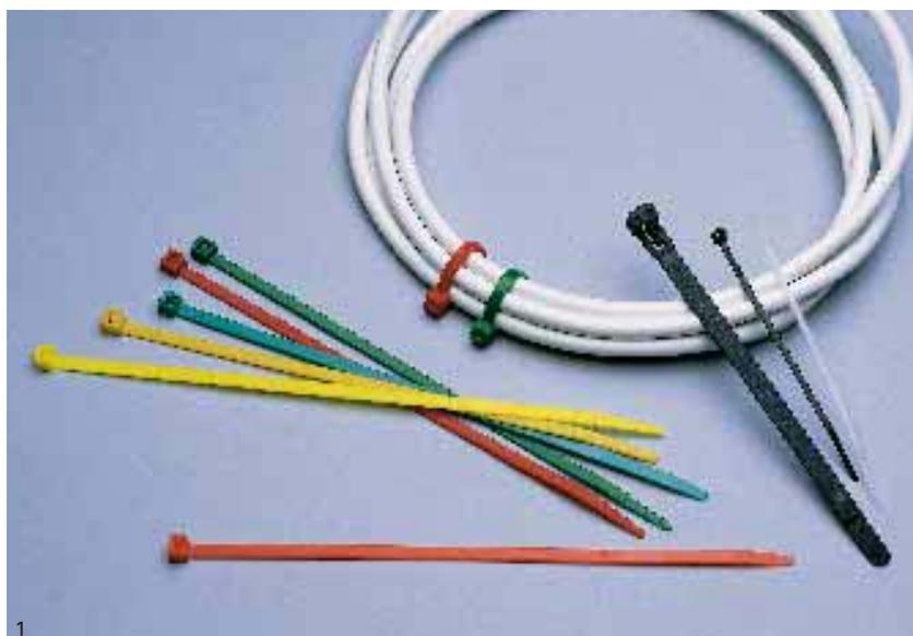
1. Эти хомуты изготовлены литьем под давлением из ненаполненного материала Зайтел®. Они обладают высокой усталостной прочностью к изгибу, стойкостью к ползучести и классом горючести V2 по классификации UL. Материал Зайтел®, за счет высокой текучести, дает возможность легко получать даже конструктивно очень сложные изделия, что в конечном счете обеспечивает короткий цикл литья.
