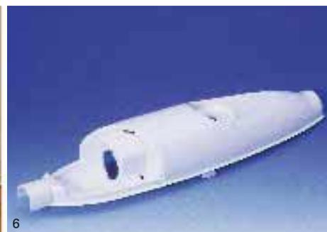
6. Материал Зайтел® 101F используется для корпуса лампы холодильника, благодаря высокому относительному удлинению, стойкости к горению V2 (по классификации UL), прекрасному качеству поверхности. Кроме этого Зайтел® 101F имеет отличную стойкость к бытовой химии и моющим средствам.
