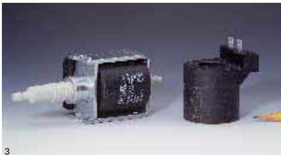
3. Сразу две марки материала Райнайт® FR530 и HP415 применяются для изготовления этого вибрационного насоса для устройства чистки ковров. Соответствие классу электроизоляции F позволяет использовать эти марки материала Райнайт® для изделий предназначенных на экспорт в США. Возможность осуществлять лазерную маркировку изделий из Райнайт® позволяет уменьшить загрязнения связанные с применением технологий маркировки на основе растворителей.
