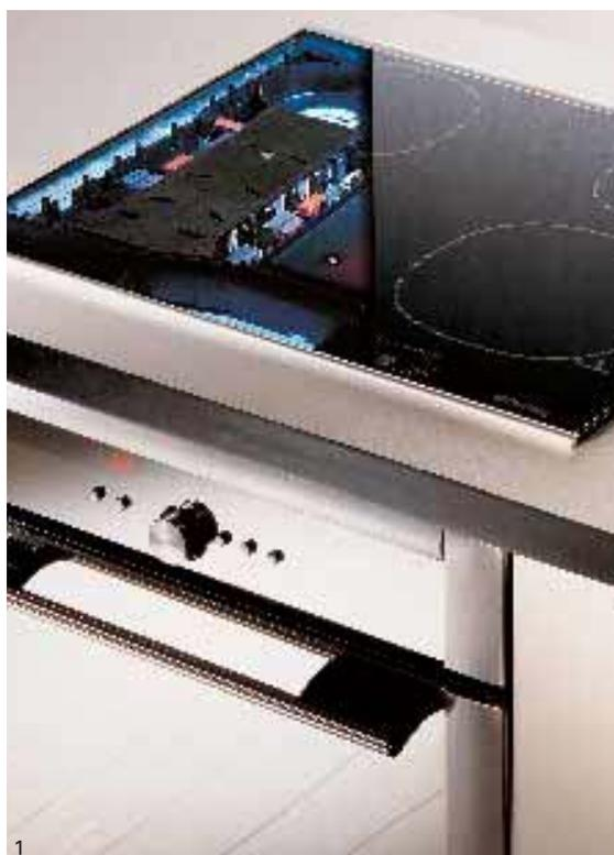
1. Показанная на рисунке индукционная конфорка производства компании «Бош-Сименс Балэй» изготовлена с применением материала Райнайт®, который был выбран из-за высокой размерной стабильности, жесткости и литевых характеристик. Марка Райнайт® FR531NC, используемая в этом изделии, разработана для эксплуатации в условиях высоких температур до 200° С.
