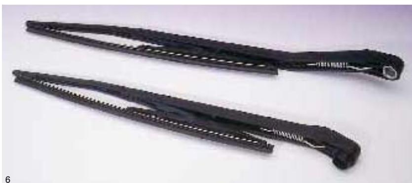
6. Рычаги задних стеклоочистителей автомобилей (например, «Пунто» компании «Фиат») изготовлены из материала Райнайт®, специально разработанного в расчете на жесткие условия эксплуатации снаружи автомобиля. Для этого изделия основное значение имеют механические характеристики и их стабильность во времени, а также стойкость к ползучести и безукоризненный внешний вид.
