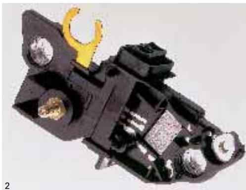
2. Материал Райнайт® 545 был выбран для корпуса разъема генератора выпущенного компанией «Бош» из-за отличной комбинации механических свойств. Дополнительными аргументами в пользу этого материала являются высокая теплостойкость, химическая стойкость и высокая производительность на многогнездных пресс-формах.
