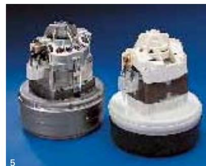
5. На рисунке показаны, применявшийся ранее электродвигатель с вентилятором, изготовленный с применением металлического литья (слева), и тот же узел новой конструкции из материала Райнайт® (справа). Переход с металла на пластмассу привел к упрощению технологии производства, снижению веса, сокращению числа деталей, снижению затрат на сборку, уменьшению объемов складских запасов и улучшению эксплуатационных характеристик широкого ассортимента пылесосов компании «Электролюкс».
