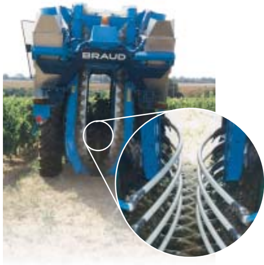
ЭРТАЛОН 66 SA "вибрационные стержни" виноградоуборочной машины
