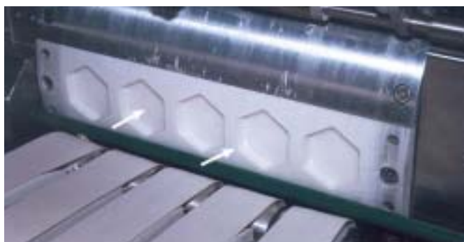
Формы и выталкивающие поршни из ЭРТАЛАЙТ для порционирования теста на выпечных машинах.
